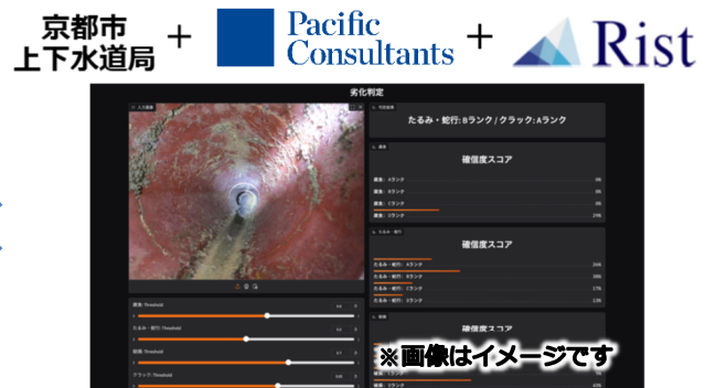
AI 下水道管劣化判定
