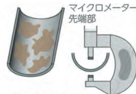
残存厚の実測 配管を半割りし、内面を観測
