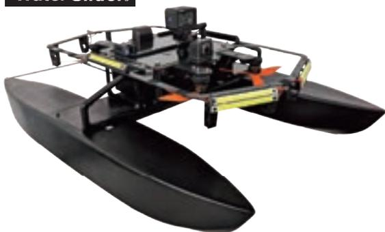
水中ドローンは、当社が水槽構造物や水路施設の点検用に開発したドローンです。水槽内や水路内を潜水して、施設情報を取得し画像解析するとともに水面近くに浮上して天井面スラブの点検を行います。上下水道だけでなくさまざまな水槽・水路構造物に適用可能です。
