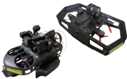
左：水上走行用ドローンWater Slider W4 右：小口径管路点検用ドローンFi4
