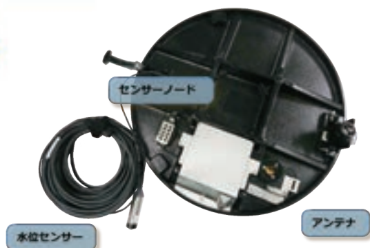
スカイマンホール IoT型水位観測システム
