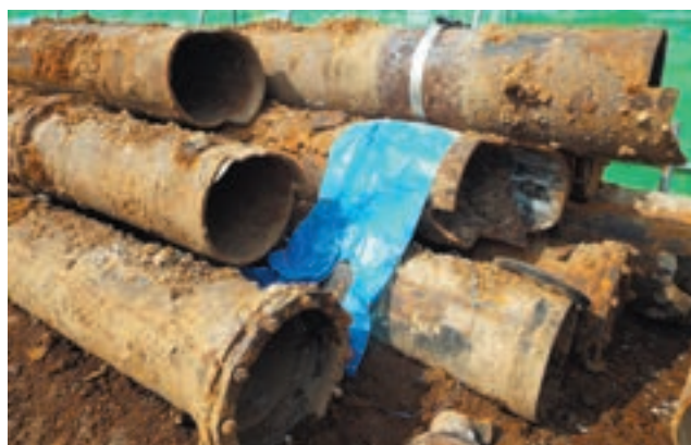
(写真) 左：水道管の破損により水が噴出 右：老朽化が進む水道管
